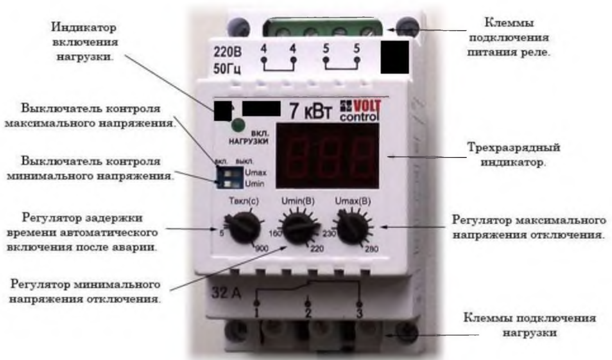
Рисунок 12. Пример маркировки устройства защиты от перенапряжения (реле напряжения)
