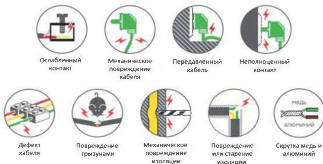
Рисунок 6. Возможные причины искрения в электропроводке
